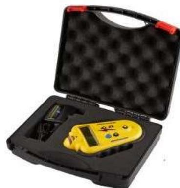
Ambos modelos funcionan con un campo magnético débil y los resultados de detección pueden verse afectados por la interferencia del teléfono móvil. Aleje sus teléfonos al menos a un metro para una mejor detección.
